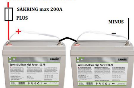
KONFIGURATION MED 2ST 100A BATTERIER SERIEKOPPLADE FÖR 24V
