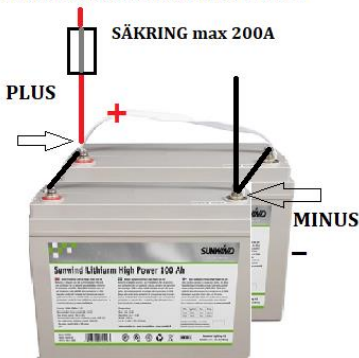
2st BATTERI I PARALLELL FÖR 12V
