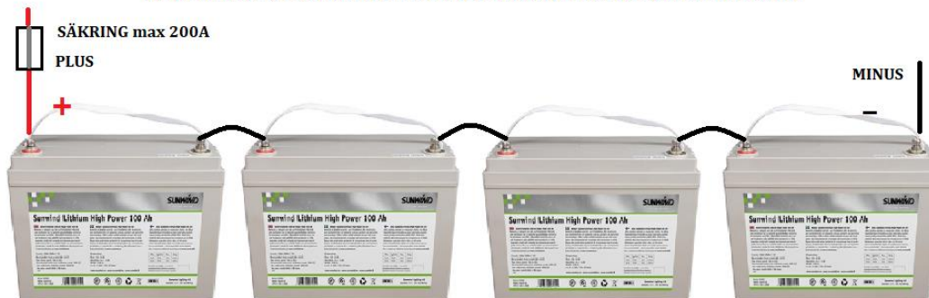
KONFIGURATION MED 4ST 100A BATTERIER SERIEKOPPLADE FÖR 48V:
